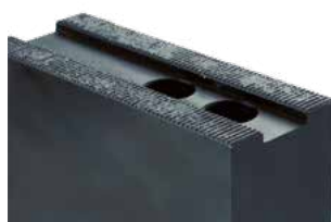
Spannbacken vor der Reinigung Serration before cleaning
