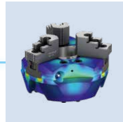
FE-Parameteroptimierung für reduzierte Korbspannungen und höchste Steifigkeiten. FE parameter optimization for reduced notch stresses and highest rigidity.
